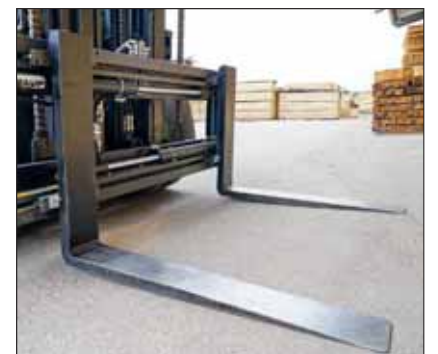
Die verwendeten Messergabeln sind rechtwinklig gekröpft, damit die Holzpakete nicht beschädigt werden.
