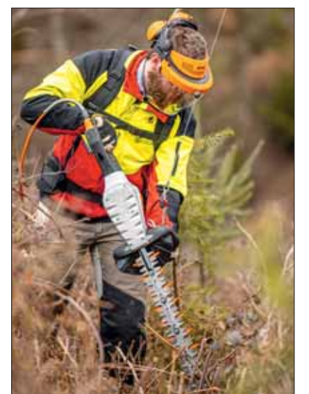
Die einschließlich Akku 4 kg schwere Heckenschere lässt sich am „Toollift“ kräftechonend und zielgenau führen.
