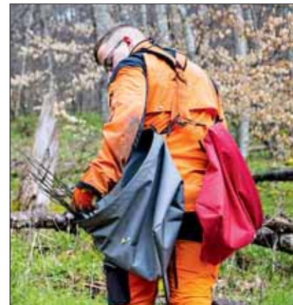
Test der Prototypen: Die Tragetaschen für die Schultergurte sollen Forstwirten dabei helfen, ihre Arbeit sicherer und gesünder zu gestalten, indem sie das Gewicht gleichmäßiger auf dem Körper verteilen.
