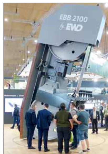
Diese Blockbandsäge von EWD wird nach der Messe an den französischen Sägewerker Moulin Scierie nach Dunières geliefert. Der Durchmesser der Rolle umfasst 2,1 m.
