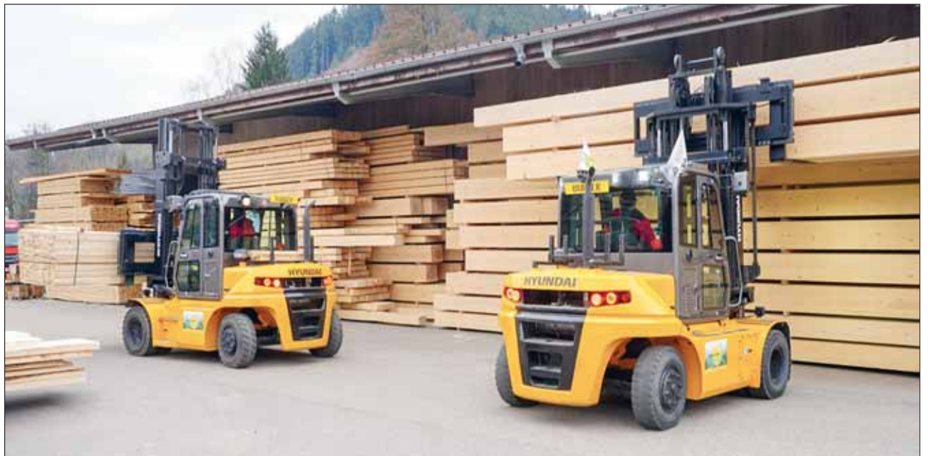
Die beiden 5- und 7-Tonner bei Burger Holzwerke in Zell/Schwarzwald beim Umschlag von Schnittholz. Sie leisten jährlich rund 1700 Stunden/Gerät. Fotos: Hyundai Construction Equipment Europe/HCEE/OBA
