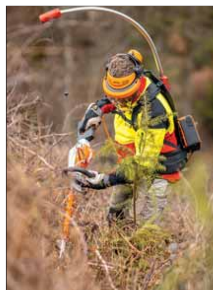
Die einschließlich Akku 4 kg schwere Heckenschere lässt sich am „Toollift“ kräftechonend und zielgenau führen.
