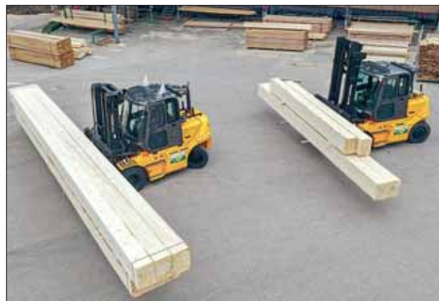
Die Stapler müssen mit verschiedenen Holzdimensionen zurechtkommen, egal ob beim Beschicken der Trockenkammern (links) oder beim Handling von bis zu 12 m langen Balken für einen Kühlturm.
