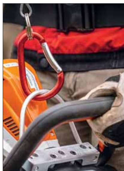
Ein selbst entwickelter Aufnahmebügel sorgt für eine ausgereifte Verbindung.
